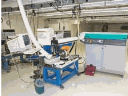
รูปแสดงระบบเอ็กไซเมอร์เลเซอร์ ที่ใช้ในงานอุตสาหกรรมการเจาะชิ้นงานโพลีเมอร์ (แหล่งภาพ http://www.spectrallytics.com/capabilities/excimerlaser.htm )
